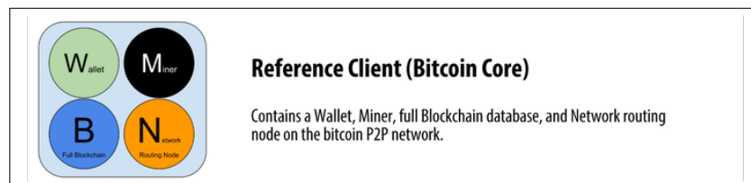
Abbildung 2: Aufgaben der Bitcoin-Node Reference Client (Bitcoin Core) [Ant15, C6]
